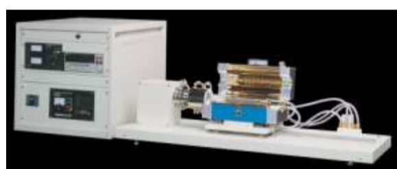
電気抵抗測定装置
